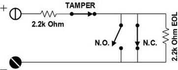
每个防区都可以通过编程定义，接常开、常闭型电阻监控回路；同时可以接一个24小时类型的回路防拆，无论系统的状态如何（布防或撤防），开路回路防拆会触发防区防拆报警信号。
