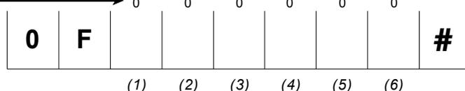
注意: 在MCM-23 Super (1#或2#) 的目标接收机为1#接收机时, MCM-23 Super的目的手机号码1在0D-0F中设置; 目的手机号码2在6F-71 (1#MCM) 或72-74 (2#MCM) 中设置。
