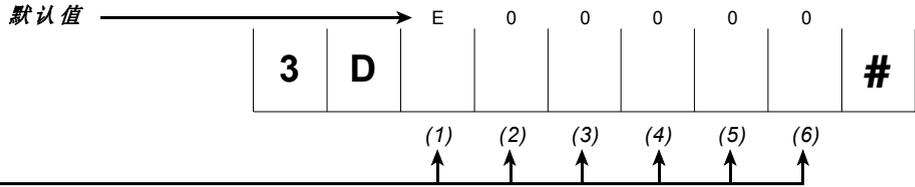
注意:在数据位(1)输入“E”会阻止控制主机占线,并中断拨号尝试。
